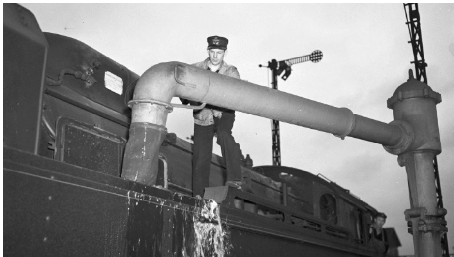
Dampkedlen fyldes op med de store 'vandkanoner' i bl.a. Hillerød og Holte
